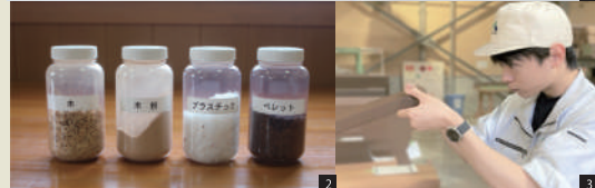
[1] 100%リサイクル素材「AO-MWood」 [2] 「AO-MWood」の材料 [3] 確かな品質を保つため、一つ一つ丁寧に作業されています。
